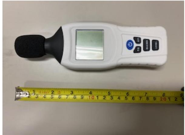
図-2 デジタル騒音計(音圧計)の外観
